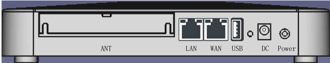
图 1-2 INTP1000 后面板示意图
